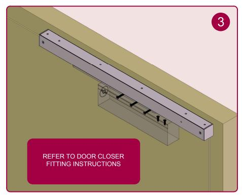
THE PINION BOLT MUST BE TIGHTENED TO 12NM
